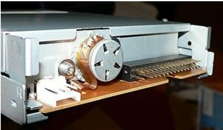
Интерфейс для подключения 3½" дисководов гибких дисков: малогабаритный разъем питания и разъем для подключения 34-контактного сигнального кабеля.
