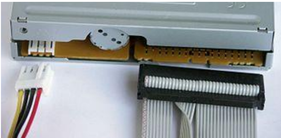
Кабели: слева питания, справа — сигнальный.
