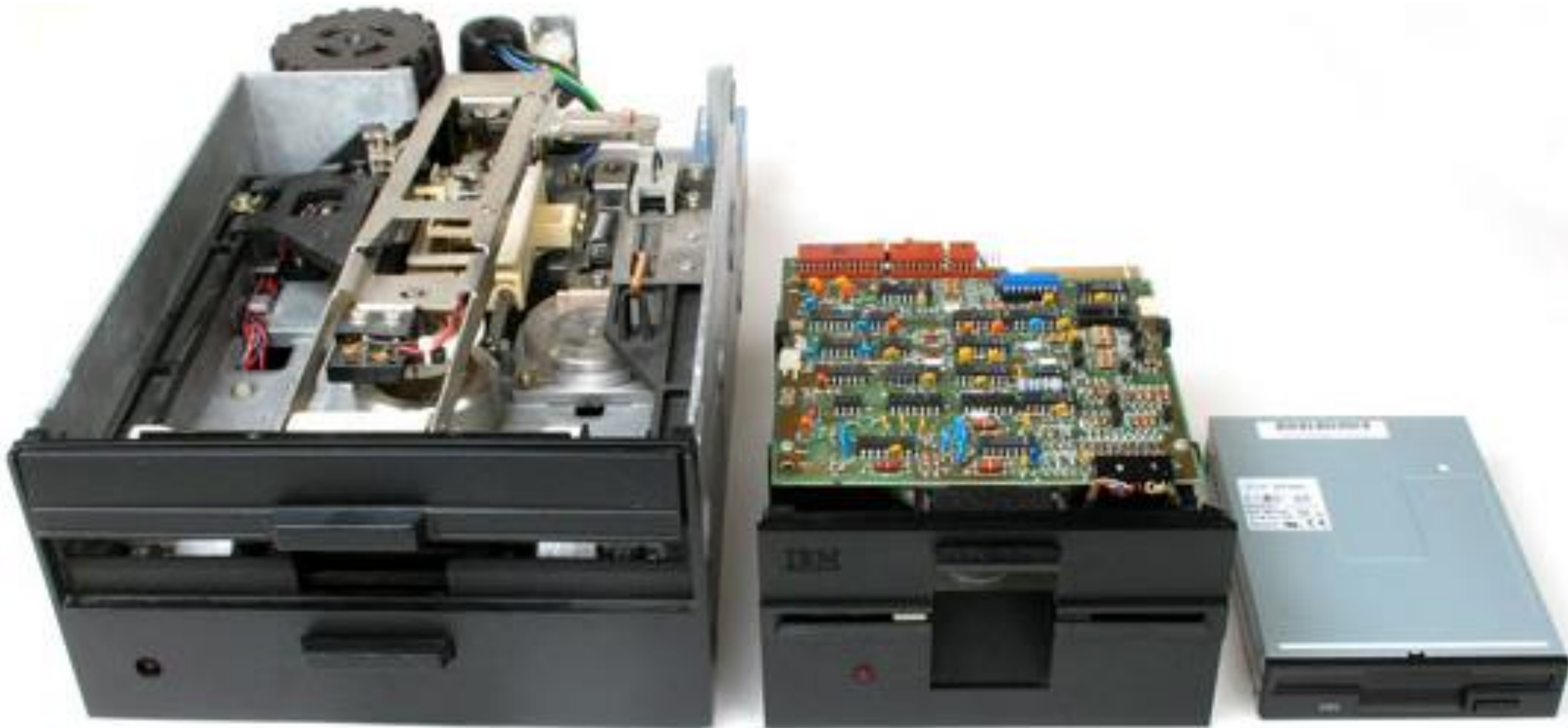
НГМД - Накопители на гибких магнитных дисках - Floppy disk drive
