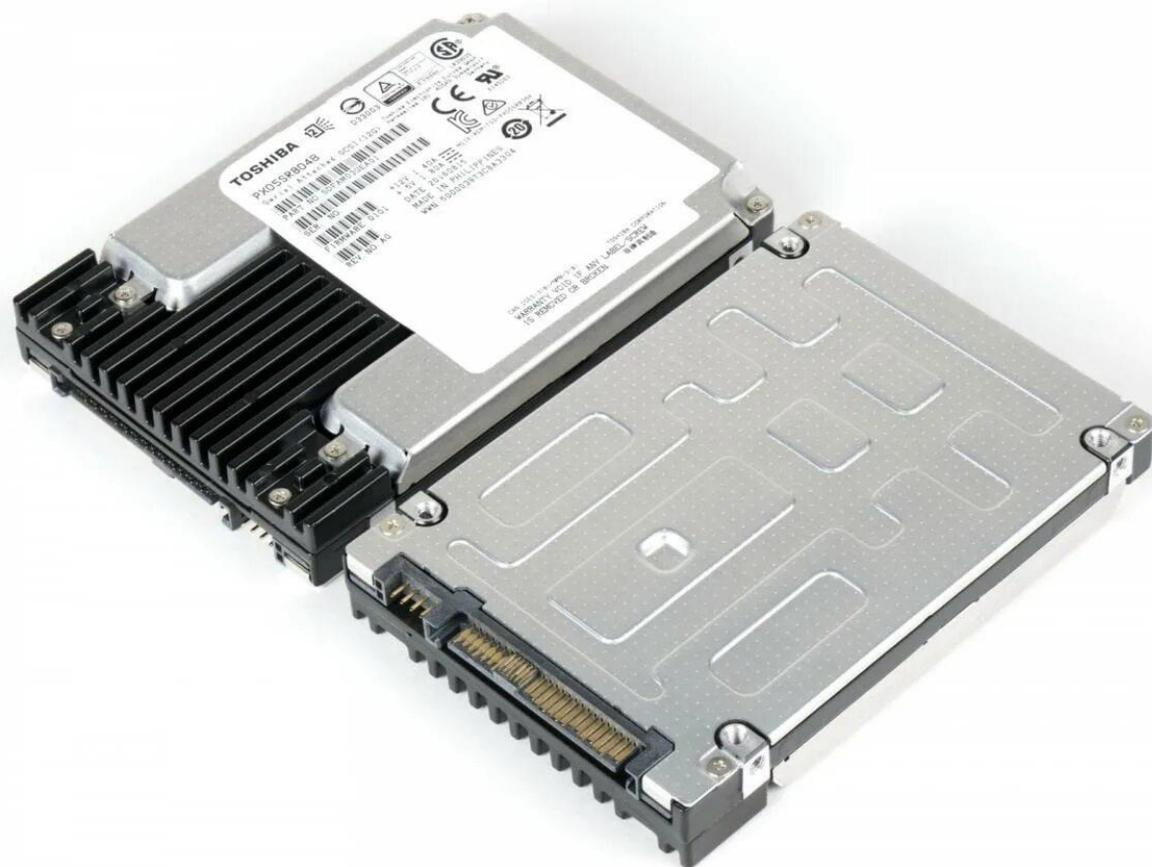
**Интерфейс Serial Attached SCSI (SAS)** был создан для использования в корпоративном сегменте, в том числе в серверах, центрах обработки данных и прочих объектах, которые можно отнести к критически важной инфраструктуре. Сегодня SSD накопители, использующие тип подключения SAS, представлены исключительно в форм-факторе 2,5 дюйма.
