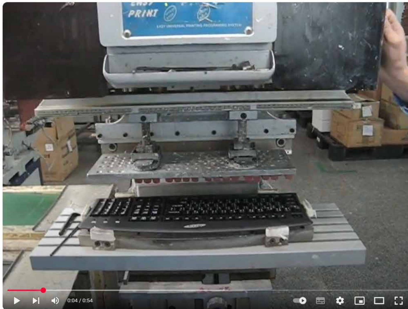
Pad Printing Machine For Computer Keyboard (2009) Pad печатная машина для клавиатуры компьютера (2009) https://www.youtube.com/watch?v=rTcLKbItCx8
