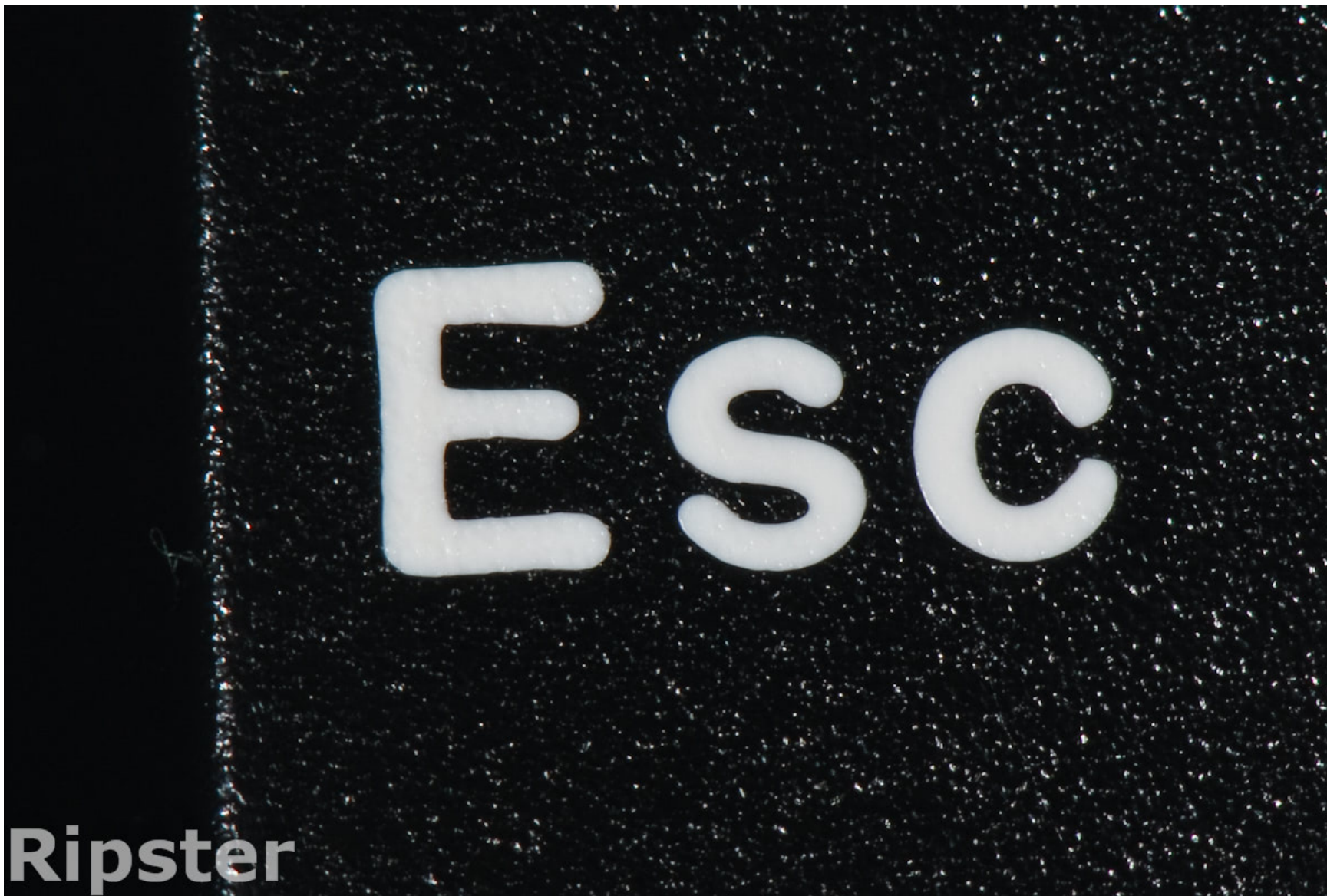
Образец кейкапа с двойным литьём (double-shot)
