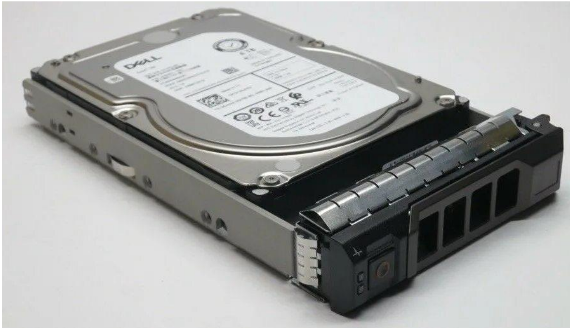
Серверный жесткий диск Dell 4Tb 7.2K 6Gb/s SAS 3.5" (400-AFBG)
